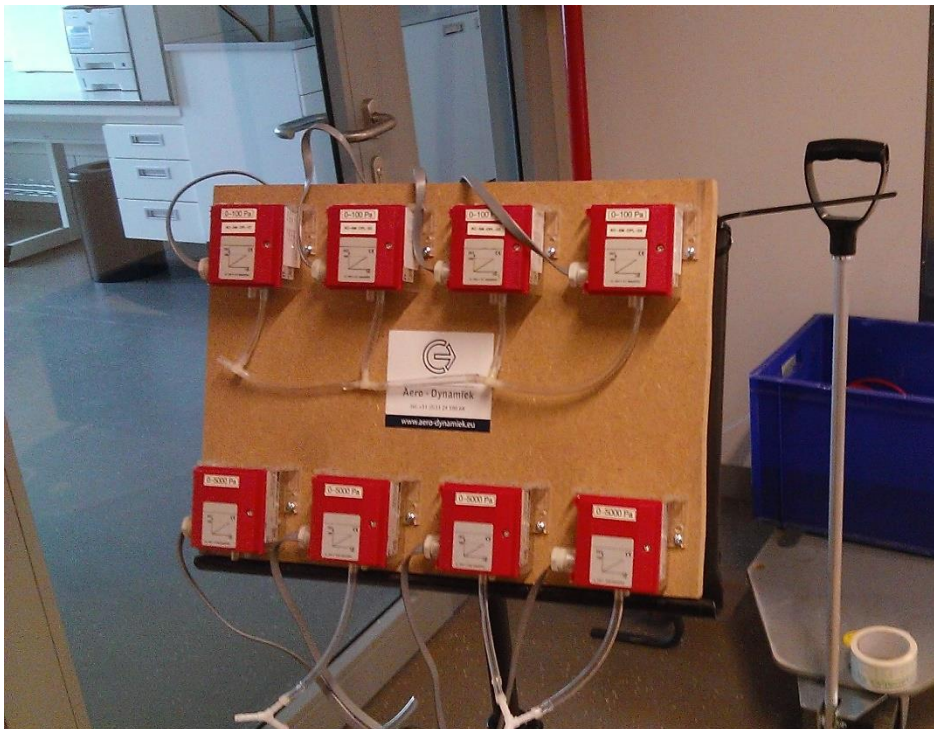
Figuur 7: opstelling meetcellen relatieve druk
