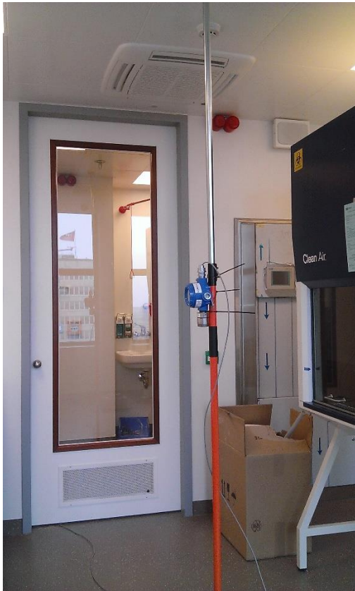
Figuur 6: opstelling meetcel zuurstofgehalte op halve hoogte
